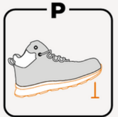
RÉSISTANCE À LA PERFORATION PLAQUE MÉTAL
